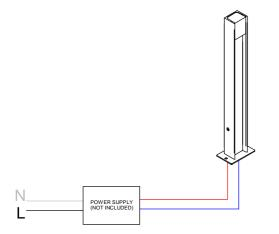
NOTE ON MULTI-OUTPUT DRIVERS: MAXIMUM ONE FIXTURE PER DRIVER OUTPUT, HOME RUN
