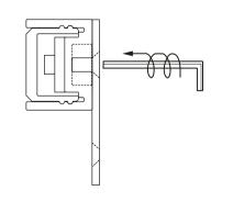
DO NOT OVER TIGHTEN TAB SCREWS
